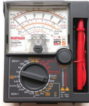
Fig. 4.2.2: Analogue multimeter
