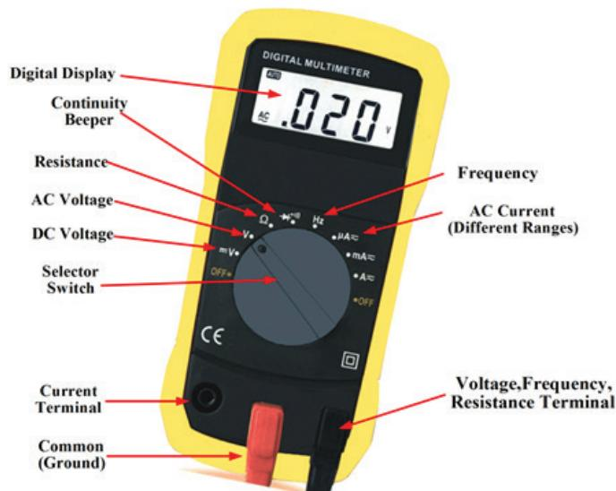
Fig. 4.2.1: Digital multimeter
