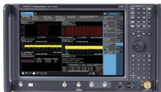
Fig 4.1.2: Spectrum Analyser
